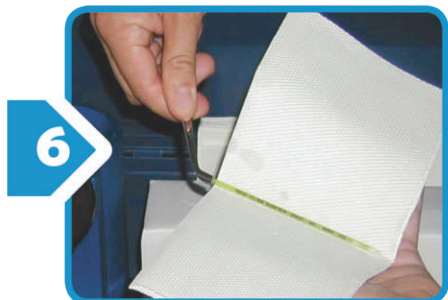
6 Saque la dosis del agua con la pinza y séquela con la toalla de papel protegiéndola de corrientes de aire.
